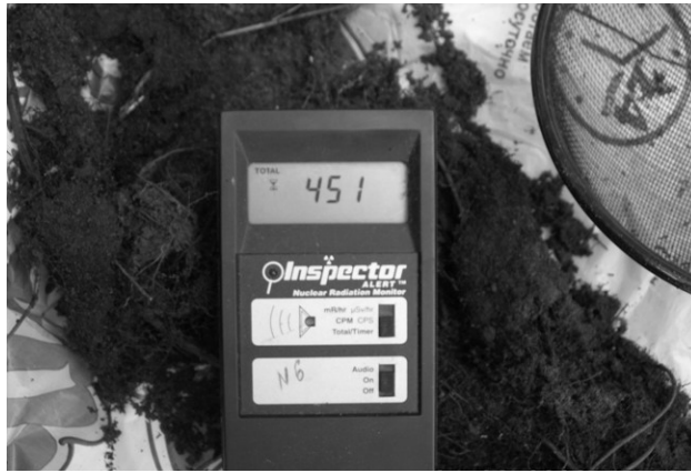
Замер радиоактивности внутренних отложений в водопроводной трубе
