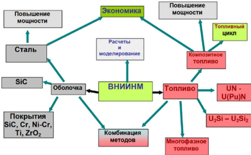
Рис. 12. Схема направлений работ во ВНИИИМ по разработке толерантного топлива [19]
