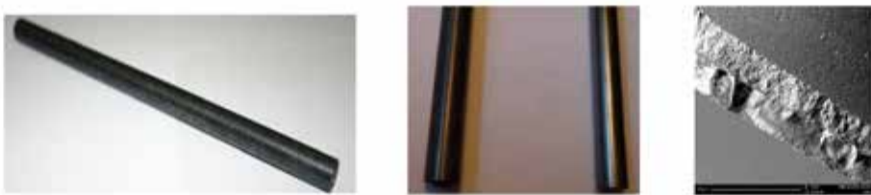
Рис. 13. Внешний вид оболочек из SiC композита и структура внешнего слоя (ВНИИИМ) [14, 19]
