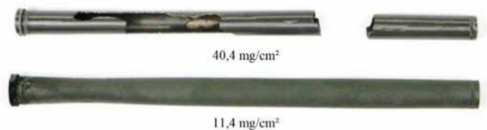
Рис. 7. Результаты испытаний непокрытых и покрытых хромом образцов в CEA [2]
