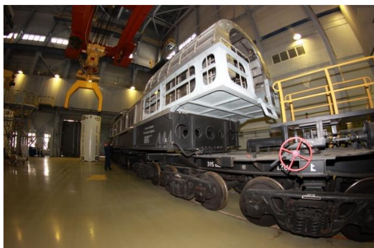
Рис 7. Транспортно-упаковочный контейнер для транспортировки ОЯТ
