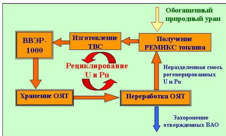
Рис 6. Схема многократного рециклирования регенерированного урана и плутония в виде РЕМИКС-топлива в реакторах ВВЭР-1000
