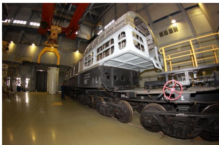
Рис 7. Транспортно-упаковочный контейнер для транспортировки ОЯТ
